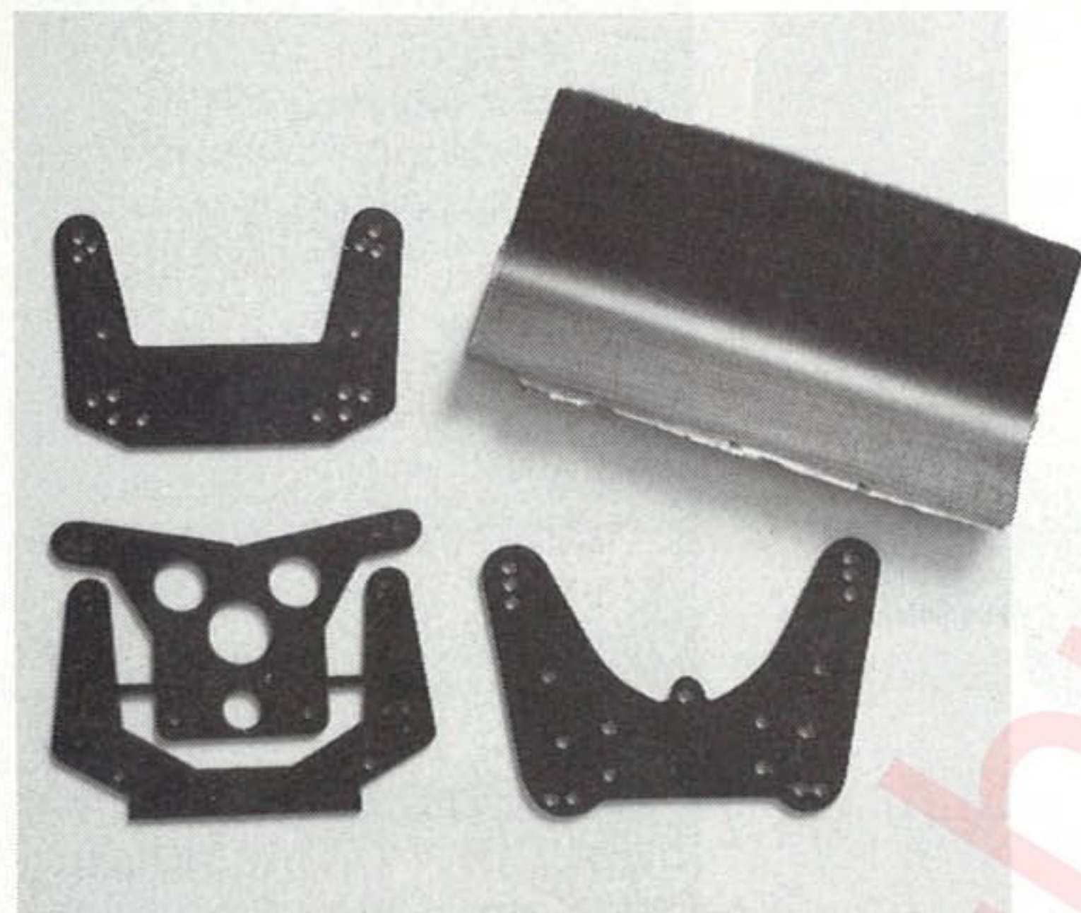
DA-11/R C-10用(12,800円) オリジナルに最も近いタイプのC-グラファイトシャーシがこれ。ストレートバッテリーはもちろん、カットにより振り分けも可能。自分のセンスに合わせてシャーシ加工したいムキには、まさにうってつけ。標準のアルミ製に比べて約40gの軽量化となる。
