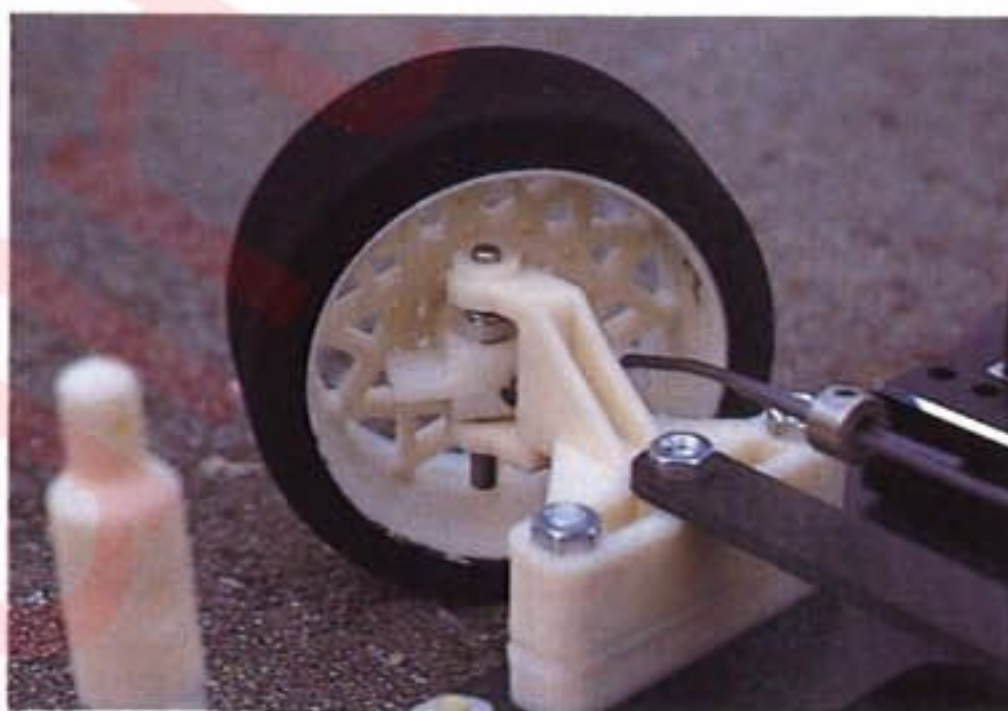
FサスはRC-12Lと同様の、樹脂製ナックルアーム にキングピン・コイルスプリングの組み合わせ。
