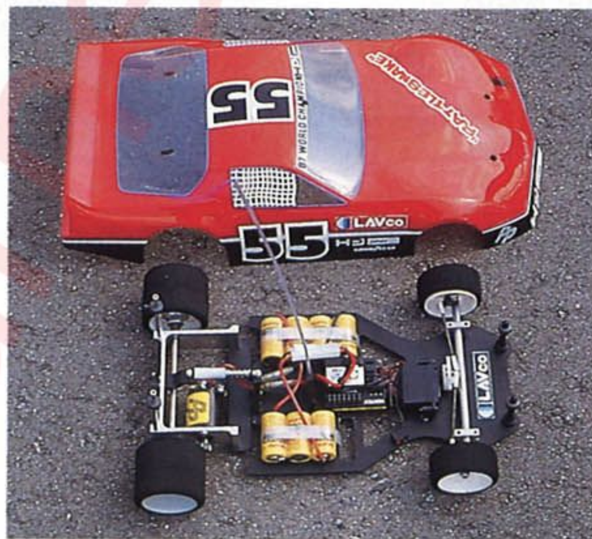
1/12をスプアアップした感の強いシャーシレイアウト。デフォ ルメされたファイアーバードのボディが標準装備。
