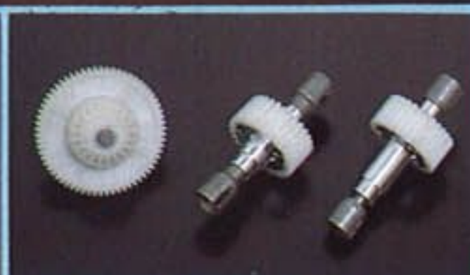
↑フロント・ワンウェイのセンターデフと、前後デフもボールタイプに進化した。必ずセットで使用する事。
