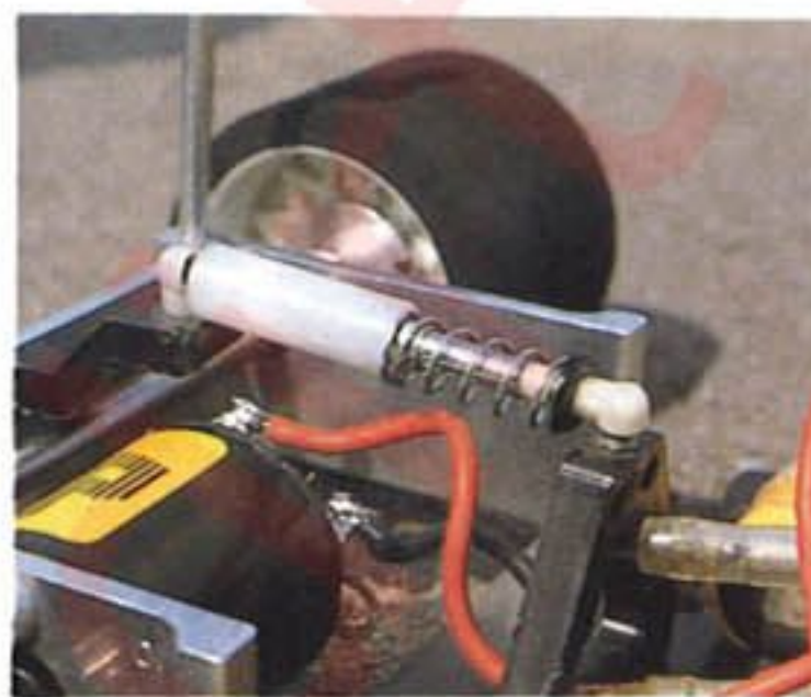
リアボットは、グリス粘度で効きを調整するフリクションダンパー制御。
