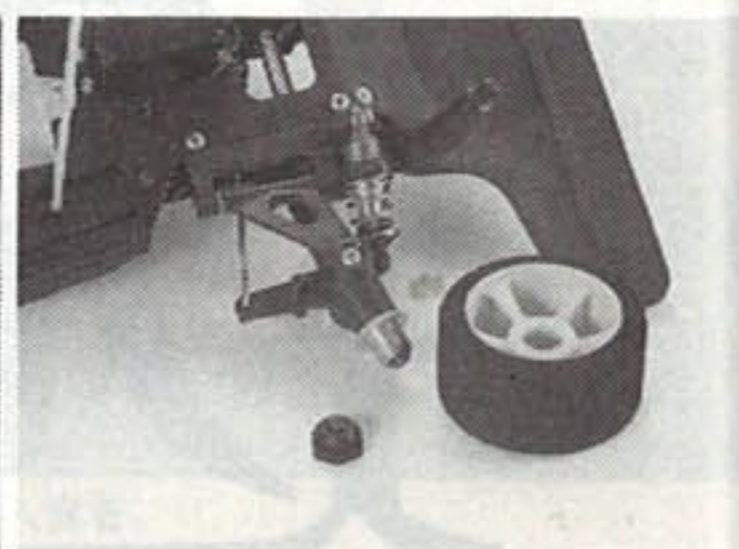
↑ベルト駆動4WD。ベルトはセンター。↑2スピードメカはシンプル設計。↑ワンタッチリリースのリヤホイール。↑ワンウェイベアリングをFに装備。
