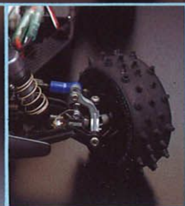
↑ダブルピンタイプの前後タイヤは新設計。やや扁平率の高いロープロタイプである。
