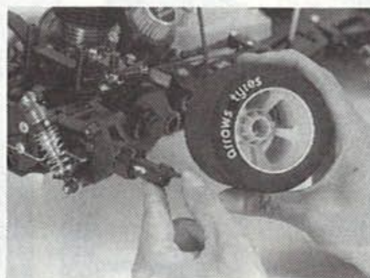
↑ベルト駆動4WD。ベルトはセンター。↑2スピードメカはシンプル設計。↑ワンタッチリリースのリヤホイール。↑ワンウェイベアリングをFに装備。
