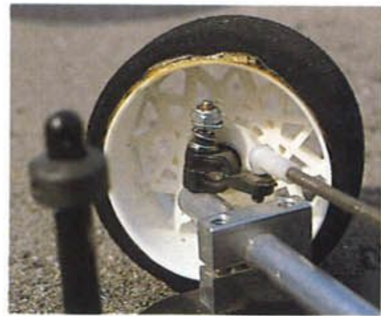
ジュラ製クロスバーにナックル／コイルスプリングを組み合わせたFサス。
